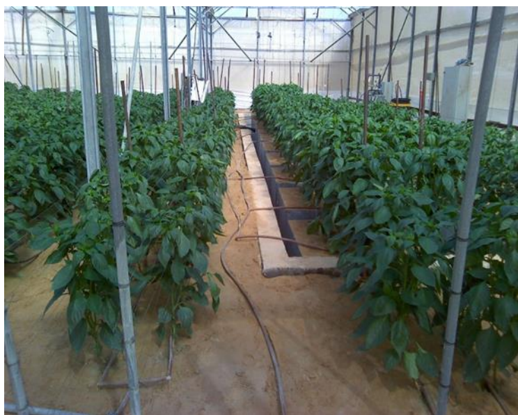
תמונה 1. ליזימטרים נשקלים בתוך תעלה וחלקות שדה בתחנת המחקר זוהר, כיכר סדום
