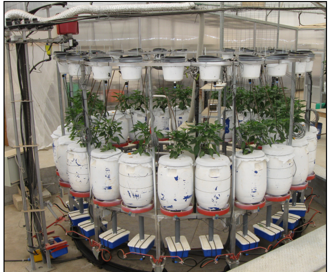
תמונה 1. מערכת לזימטרים וניסוי פלפל בגילת. 03/11/09.
