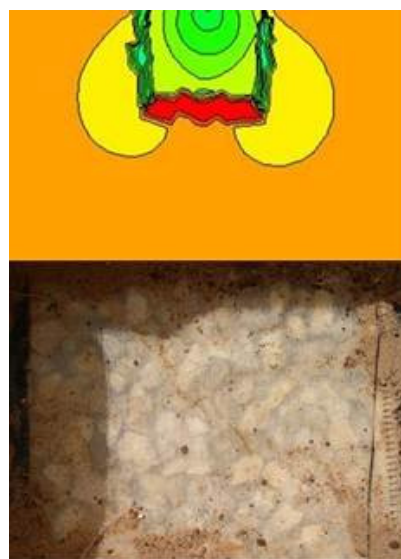
איור 1. הדמיה של תנועת המים מטפטפת כאשר בקרקע מוטמן מחסום קפילרי
