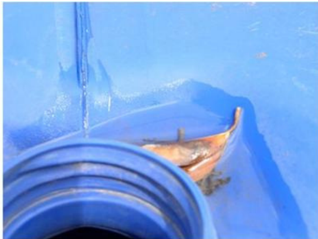
תמונה 1. כוחות ספיחה על פני חבית פוליאטילן מושכים את המים אל פני הדופן מעל גובה פני השלולית.
