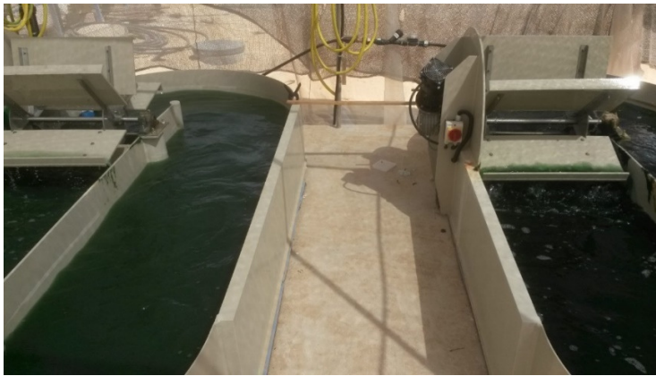
תמונה 2: גידול ספירולינה בבריכות raceway
